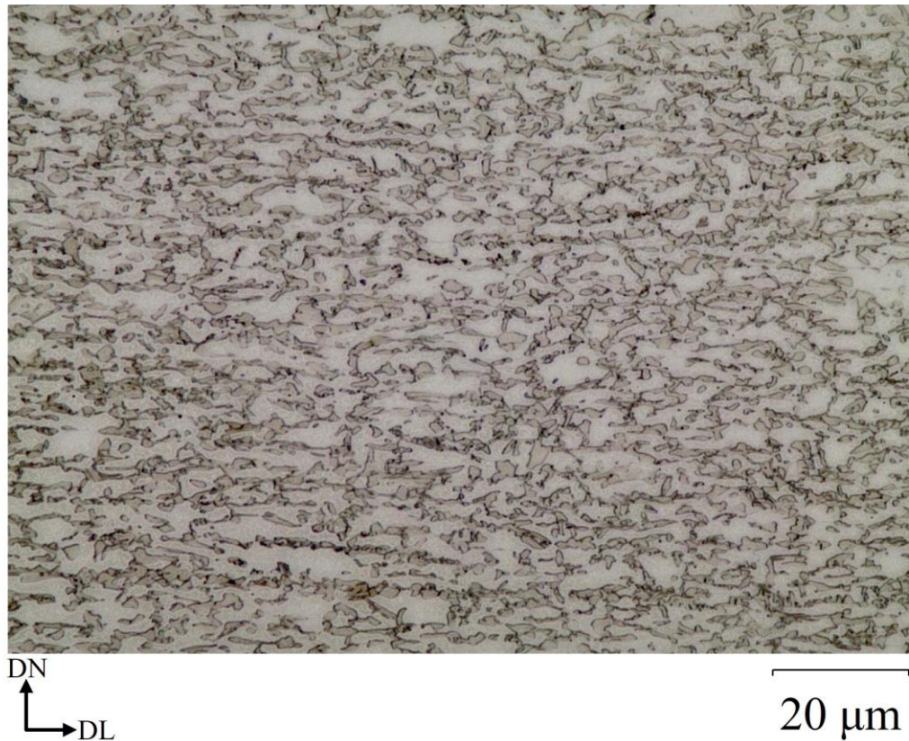
Micrografia 8 — Chapa de aço TRIP 780 após fratura. Ataque químico com Nital 2%. Aumento de 1000x
