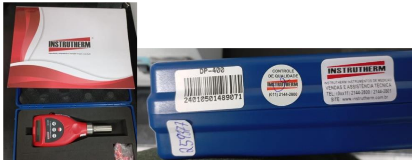
Figura 24: Detalhes do durômetro utilizado nos ensaios mecânicos.
