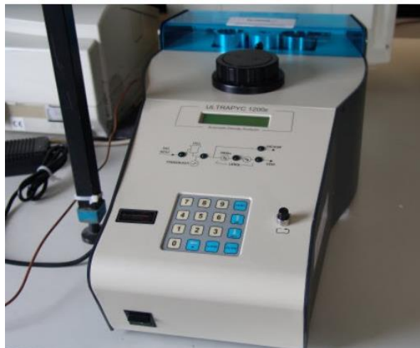
Figura 21: Imagem do picnômetro de gás hélio QUANTACHROME Ultracyc 1200e utilizado neste trabalho
