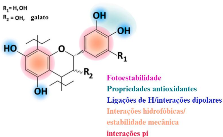
Figura 5. Componentes estruturais responsáveis pelo desenvolvimento das propriedades físicas em biopolímeros contendo taninos.
