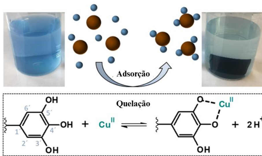
Figura 4. Mecanismo de adsorção de Cu(II) por taninos.
