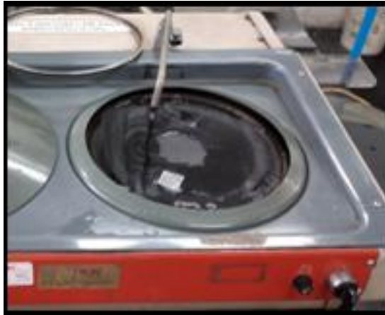
Figura 22 - O CP sendo lixado na politriz para retirada de óxidos de sua superfície
