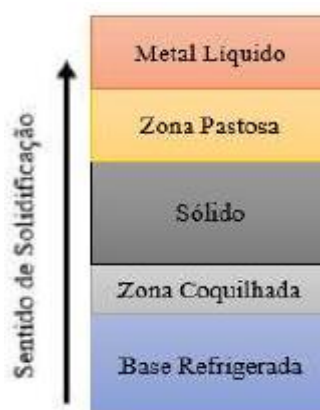
Figura 34 – Figura esquemática do sentido ascendente de solidificação.
