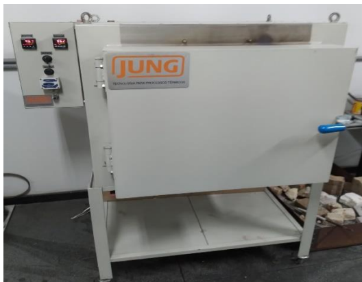
Figura 28 – Forno elétrico tipo mufla, modelo FE7013, fabricante Jung.
