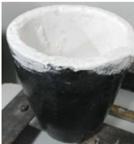
Figura 27 – Cadinho de carbeto de silício revestido com alumina.
