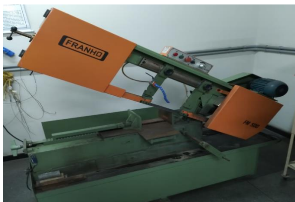
Figura 25 – Serra fita, modelo FM500, marca Franho.
