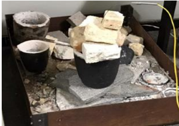
Figura 30 – Cadinho posicionado na zona de proteção para o processo de resfriamento lento.
