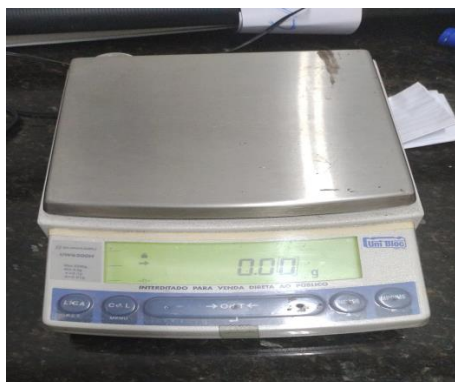
Figura 26 – Balança digital de precisão, modelo UW6200H, marca Shimadzu.
