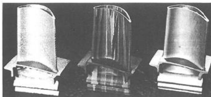
Figura 24 – Macroestruturas de lâminas de turbina de uma liga à base de níquel: da esquerda para a direita estrutura equiaxial, colunar e monocristalina.
