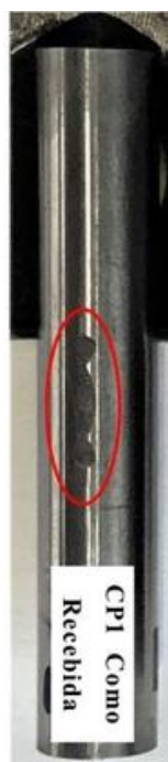
Figura 8 – Marcas de Fretting entre mola e vareta combustível após a realização do ensaio experimental.
