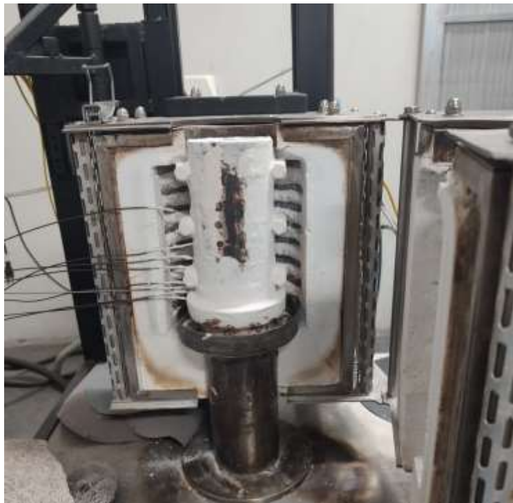
Figura 17: Lingoteira posicionada no forno de indução para a solidificação unidirecional ascendente. Abaixo dela, o sistema de arrefecimento.
