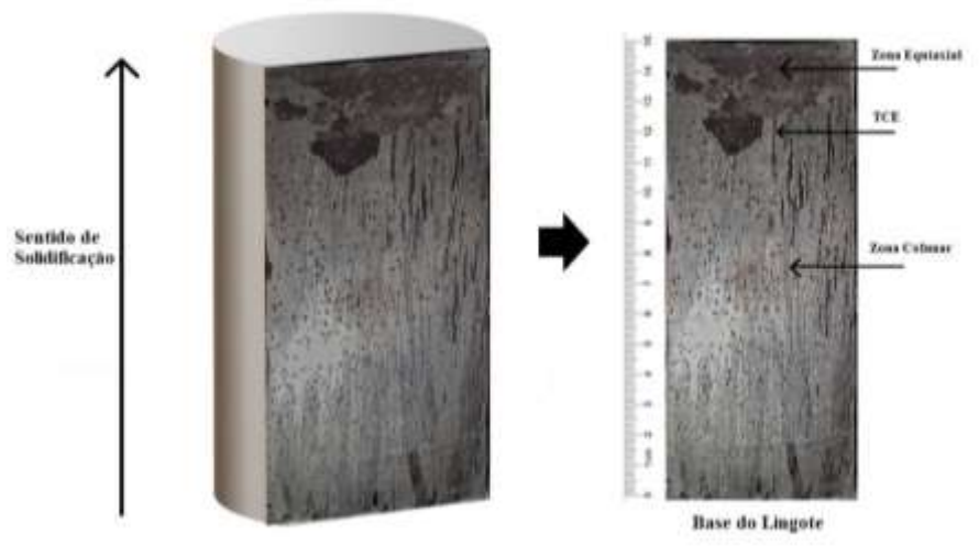
Figura 38: Macrografia da seção longitudinal do Lingote solidificado para a liga Al-5%Si-4%Cu-1%Ni.
