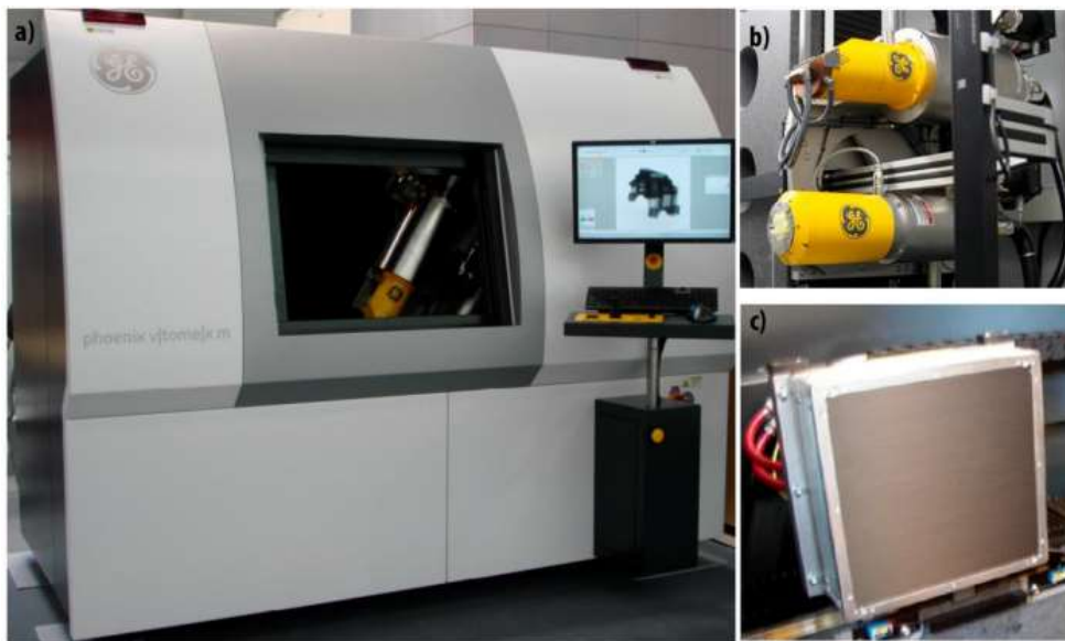
Figura 26: Microtomógrafo Phoenix: (a), dois tubos de raio X, na parte superior o tubo de microfoco e abaixo o de nanofoco (b) e detector Flat panel (c).
