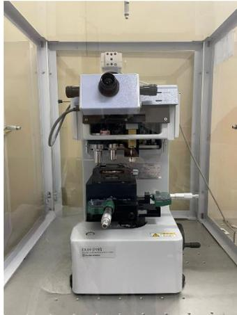
Figura 9 - Microdurômetro SHIMADZU DUH-211S Campus UFF/Aterrado, Volta Redonda/RJ (Autor)
