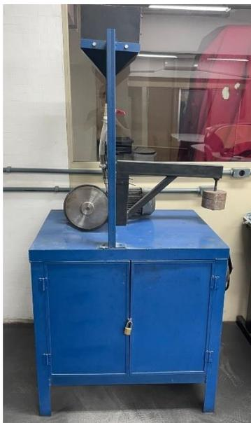
Figura 11 - Abrasômetro tipo roda de borracha para ensaios de desgaste (Autor)
