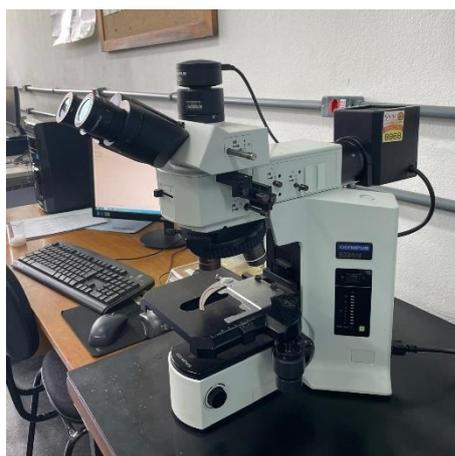
Figura 8 - Microscópio óptico Olympus BX51M do Laboratório de Caracterização de Materiais da EEIMVR/UFF (Autor)
