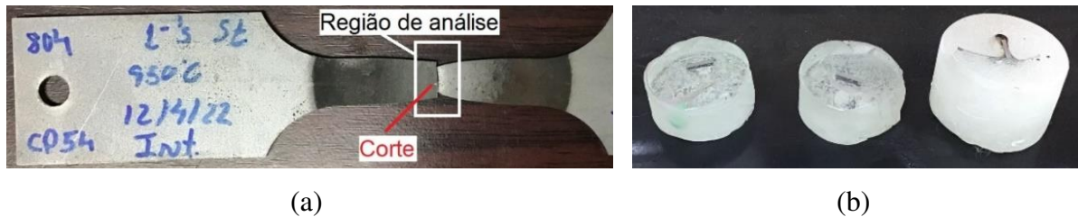
Figura 85 - Preparação metalográfica. (a) Localização do corte para embutimento. (b) embutimento a frio feito com resina epóxi.
