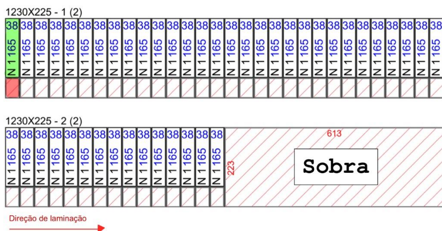
Figura 62 - Esquema do plano de corte elaborado com auxílio do aplicativo SketchCut Lite para IOS.
