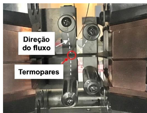
Figura 63 - Posicionamento do sistema de bicos sopradores com gás Argônio.
