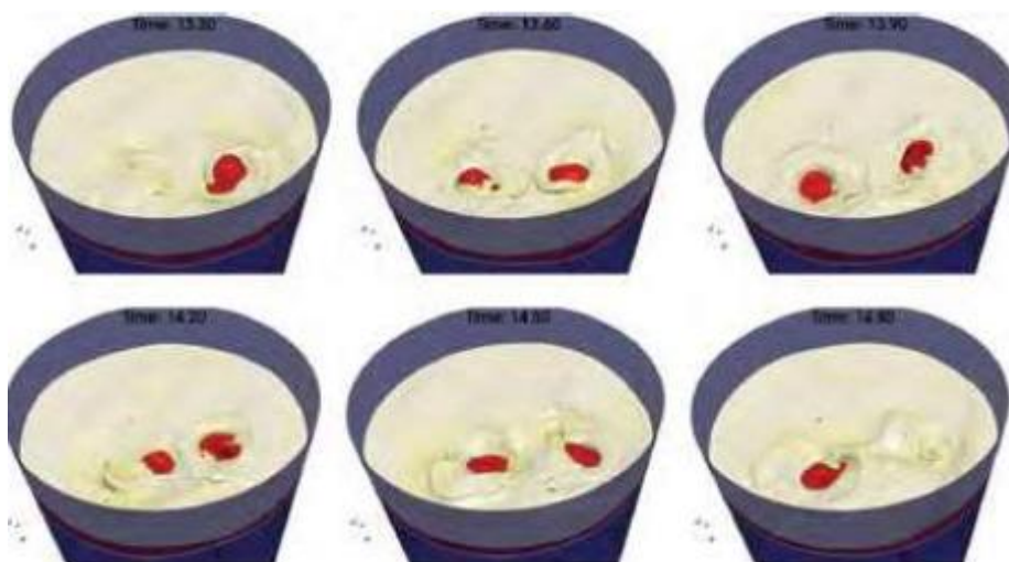
Figura 10: Resultados de simulação de bolhas de Argônio em uma panela com dois plugues refratários, mostrando variações no olho aberto na interface metal/escória em intervalos de 0,3s. Fonte: [36].
