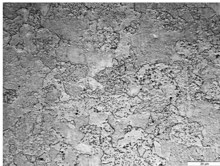
Figura 43: Microestrutura do aço AISI 420D como recebido.
