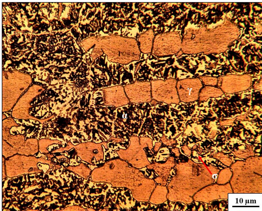
Figura 35 – Micrografia da amostra tratada a 700°C por 50h, aumento 500X, ataque Behara. Fonte: A autora.
