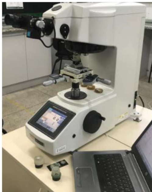
Figura 43. Microdurômetro Mitutoyo HM-210, utilizado na medição da microdureza Vickers. (Garção, 2023)
