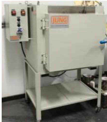
Figura 25. Forno elétrico tipo mufla do laboratório de Solidificação da EEIMVR-UFF, modelo FE7013, fabricante Jung.
