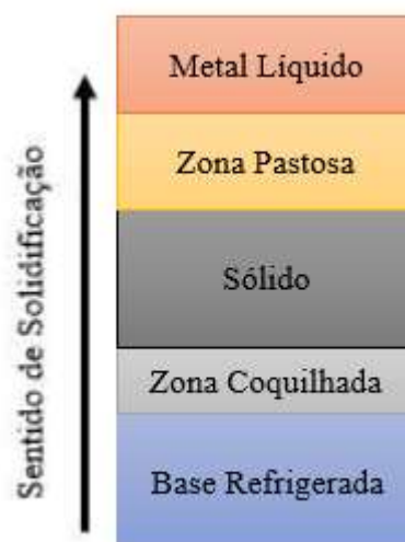
Figura 31. Figura esquemática do sentido ascendente de solidificação.
