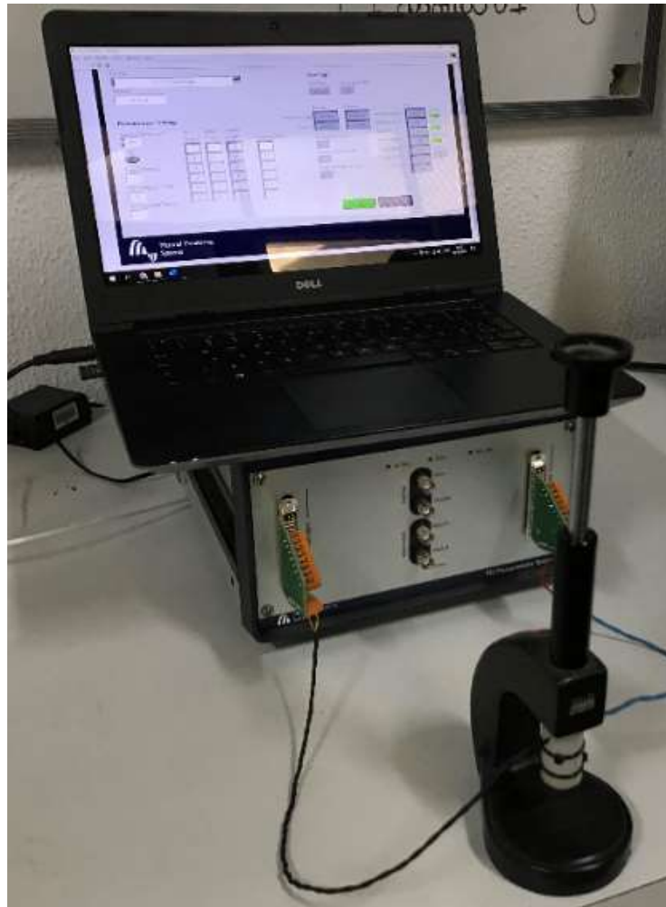
Figura 46. Equipamento de medição da resistividade elétrica PD Measurement System instalado no Laboratório de Ensaios Não Destrutível da PGMEC na UFF-Niterói.
