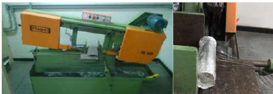
Figura 34. (a) Máquina de corte (b) Lingote cortado para o aproveitamento dos termopares.
