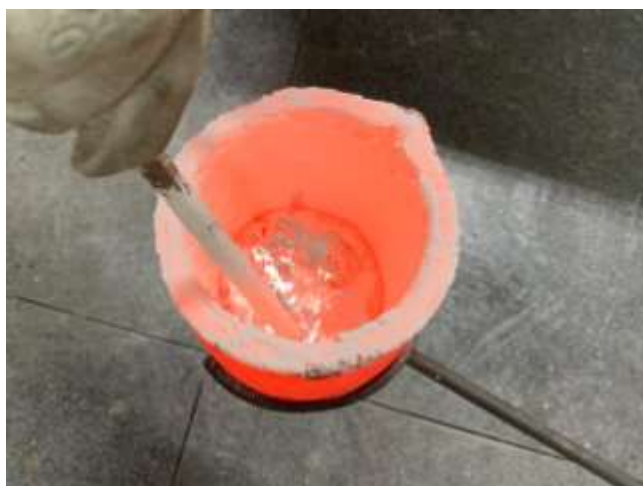
Figura 26. Homogeneização do soluto no solvente, com auxílio da garra metálica e haste.
