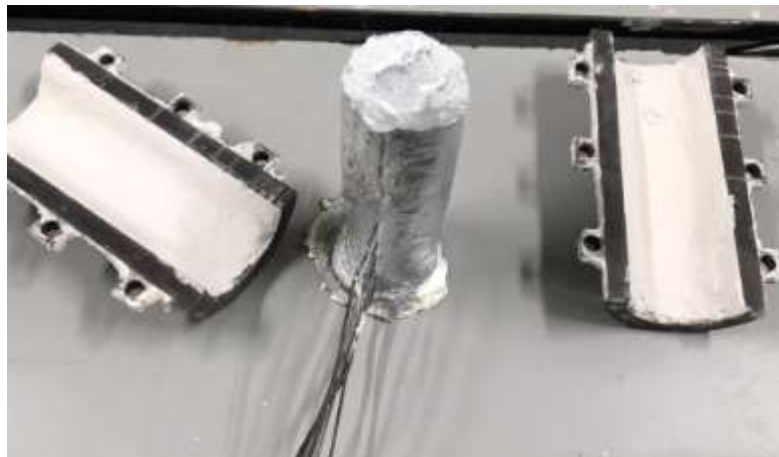
Figura 33. Lingote com 15 cm após a solidificação.
