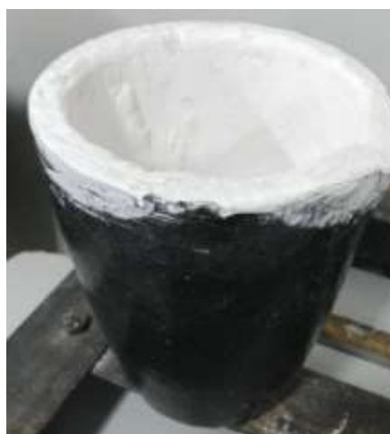
Figura 24. Cadinho de carbetto de Silício.
