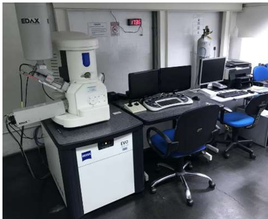
Figura 40. MEV com software EDAX para análise química através de EDS no laboratório da EEIMVR.
