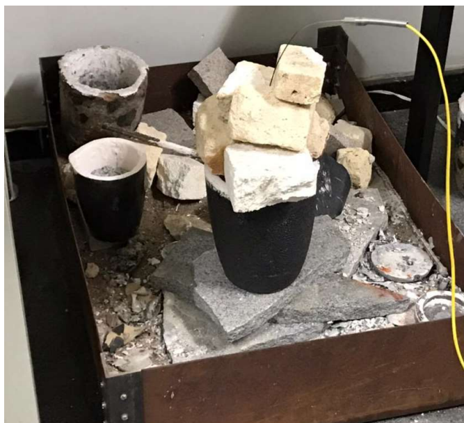
Figura 29. Processo de resfriamento lento com cadinho e termopar, posicionado na zona de proteção.
