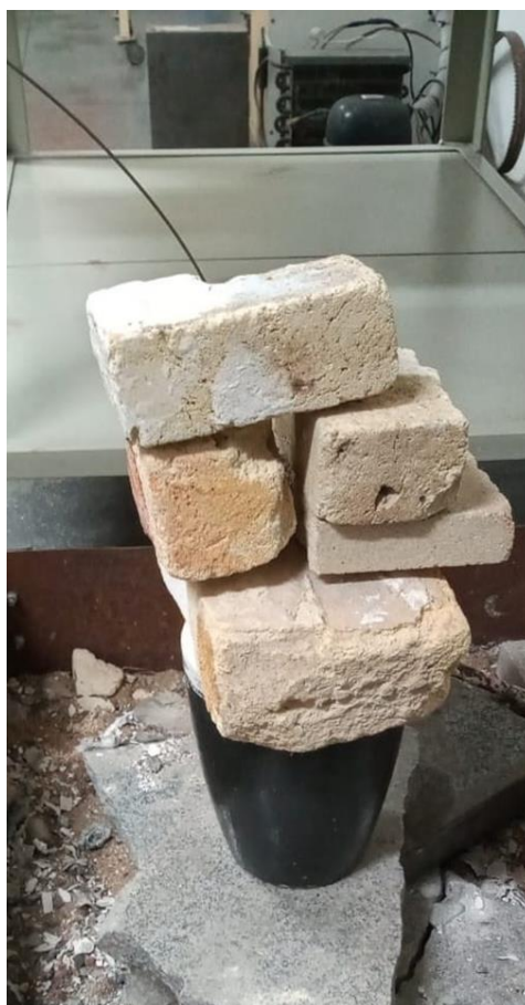
Figura 45 – Esquema do cadinho com termopar posicionado para solidificação com resfriamento lento.
