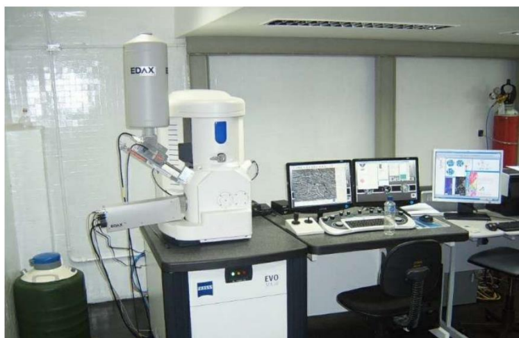
Figura 41 – MEV com software EDAX para análise química através de EDS em um dos laboratórios da EEIMVR.
