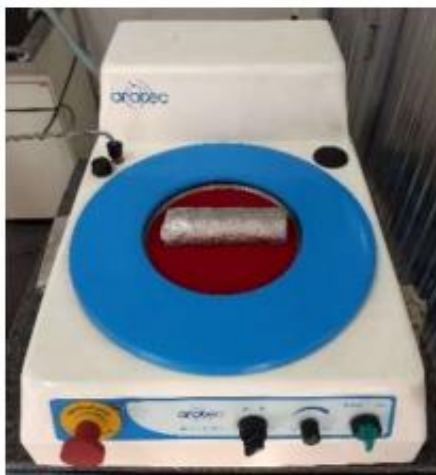
Figura 32 - Lixadeira e politriz metalográfica.
