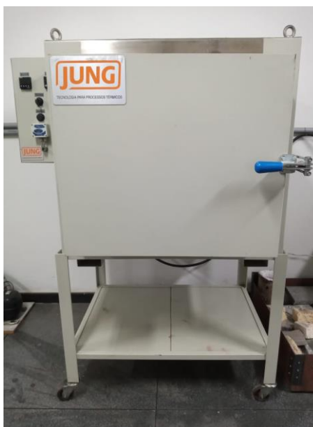
Figura 27 - Forno elétrico tipo mufla usado para fundição.
