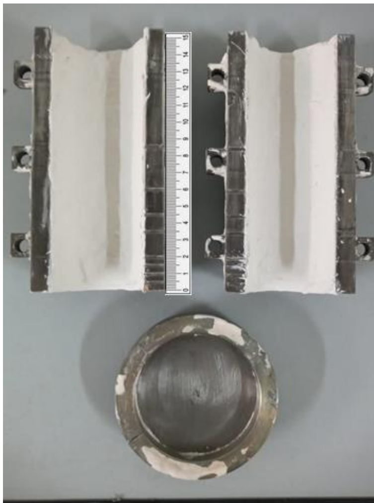
Figura 29 - Molde bipartido revestido com solução à base de alumina.
