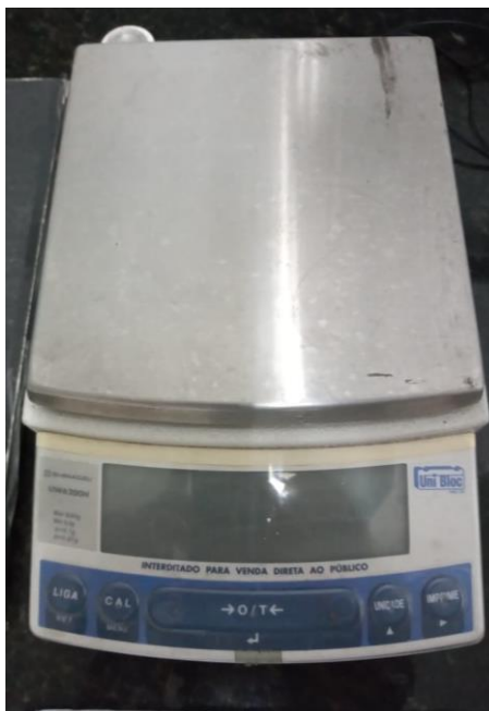
Figura 25 - Balança digital usada nas preparação da liga.
