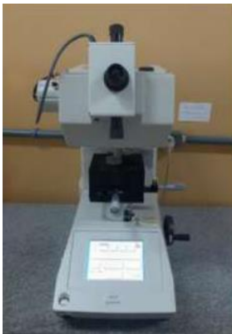
Figura 44 - Microdurômetro utilizado na medição da microdureza Vickers.
