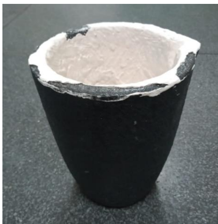
Figura 26 - Cadinho de carbetto de silício usado para fundir a liga.
