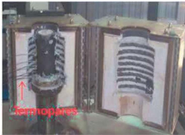
Figura 35 - Posição dos termopares na lingoteira vista lateral (GARÇÃO, 2018).
