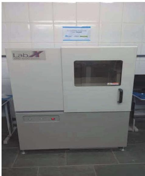
Figura 50 - Difratômetro de Raios-X marca SHIMADZU.
