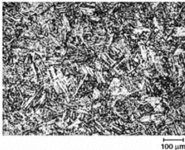
Figura 4: Matriz de aço inoxidável martensítico (Dureza Rockwell C = 41 HRC), ASM Metals Handbook, vol. 9, 2004.
