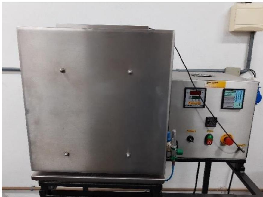
Figura 4.12 – Forno de sinterização FE50RPN.
