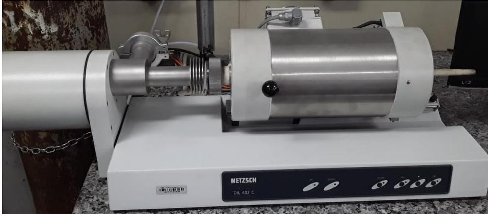
Figura 4.10 – Dilatômetro Netzsch DIL 402 C da Universidade Federal Fluminense/Volta Redonda.
