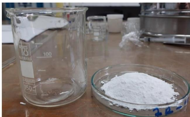
Figura 4.3 – Do lado esquerdo, gel de CMC, e do lado direito,  $\text{Al}_2\text{O}_3$  momentos antes da mistura para produzir a tinta cerâmica.
