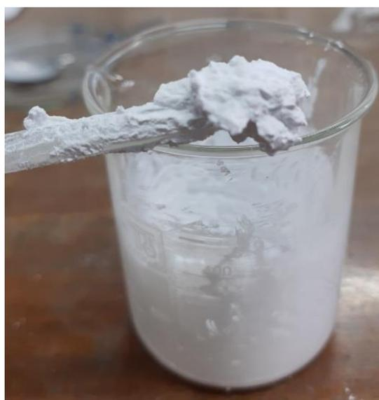
4.4 – Tinta de  $\text{Al}_2\text{O}_3$  produzida com 50% em peso de gel CMC e 50% em peso de pó.
