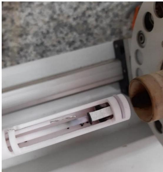
Figura 4.11 – Detalhe da acomodação da amostra para realização da dilatométrica.
