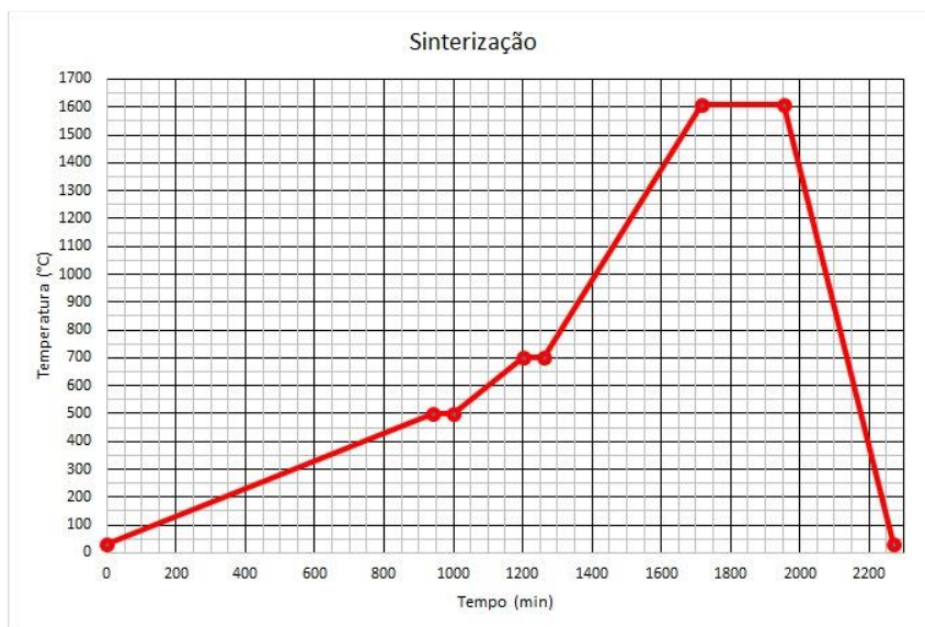
Figura 4.3: Ciclo de sinterização dos compósitos \text{Al}_2\text{O}_3 -YAG com gradiente composicional. Fonte: O autor
