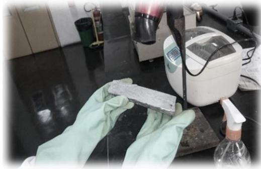
Figura 49: Ataque químico do lingote, Laboratório de Solidificação Controlada – UFF- EEIMVR.
