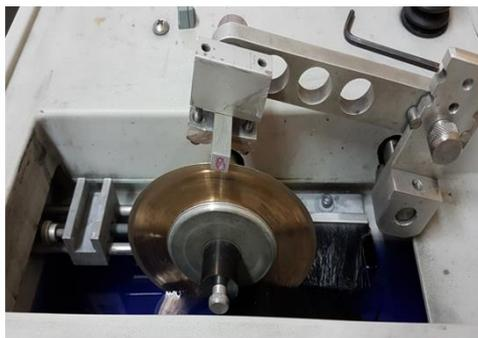
Figura 50: Serra de precisão para os cortes transversais, Laboratório de Solidificação Controlada – UFF- EEIMVR.
