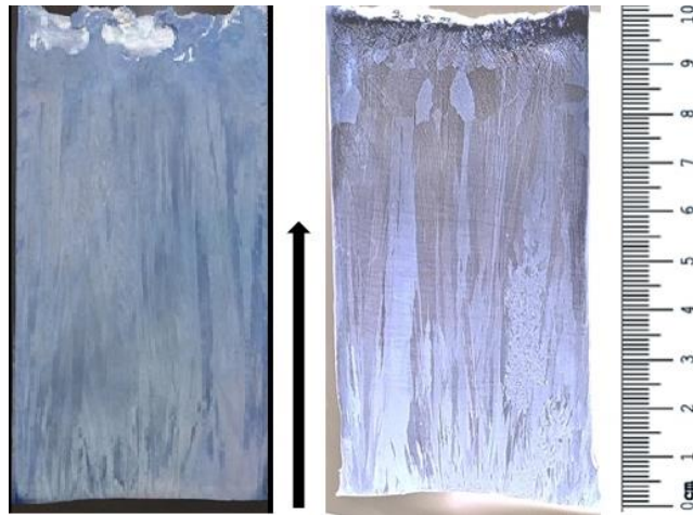
Figura 26 - Macrografias dos lingotes: liga Cu- 20%Sn (esquerda) e Cu-15%Sn (direita).
