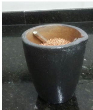
Figura 13 - Cadinho de carboneto de silício contendo Cu eletrolítico e Sn.
