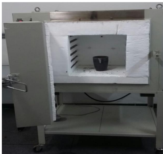
Figura 14 - Cadinho de carboneto de silício contendo Cu e Sn eletrolítico.
