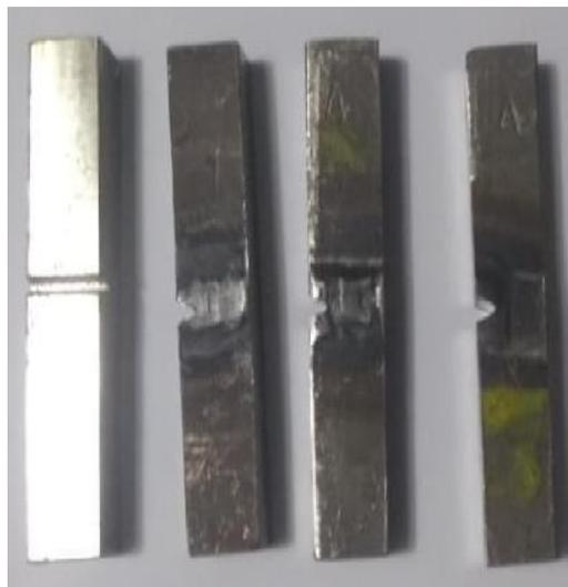
**Figura 39.** Corpos de provas para Charpy após os experimentos 0T, 2,5T, 5,0T e 7,5T.
