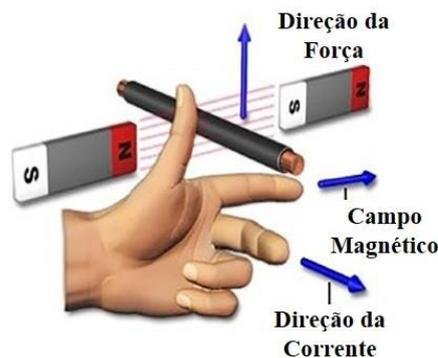
**Figura 18.** Regra da mão esquerda de Fleming (Singh et al., 2021).
