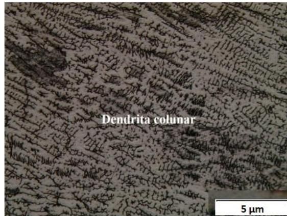
**Figura 51.** Micrografia revelando a dendrita colunar na ZF. Figura da soldagem com o campo magnético externo de 7,5 T.
