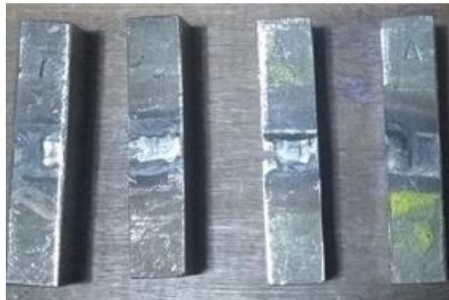
**Figura 33.** Exemplo de amostras das juntas soldadas após o corte com serra fita.
