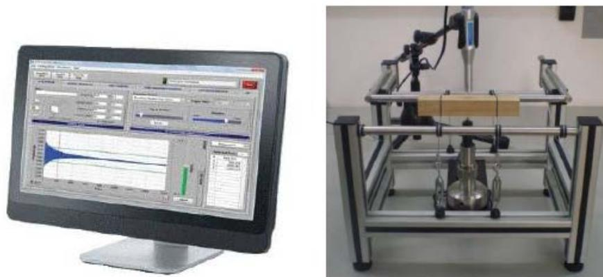
Figura 5.2 - Equipamento desenvolvido pela ATCP Engenharia Física (Sonelastic®) para medição dos módulos elásticos empregando a Técnica de Excitação por Impulso. (Fonte: OTANI, 2017)
