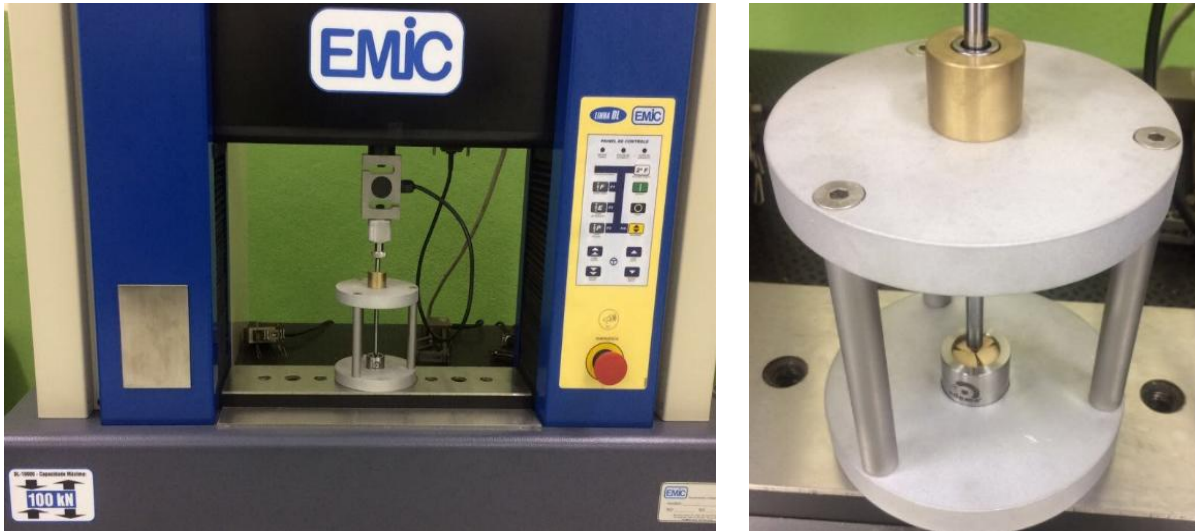
Figura 9- Montagem e realização dos ensaios de flexão biaxial. Fonte: Autora.
