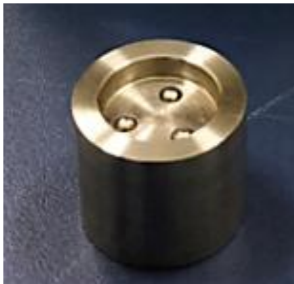
Figura 8- Suporte utilizado para realizar o ensaio de flexão biaxial. Fonte: autora.
