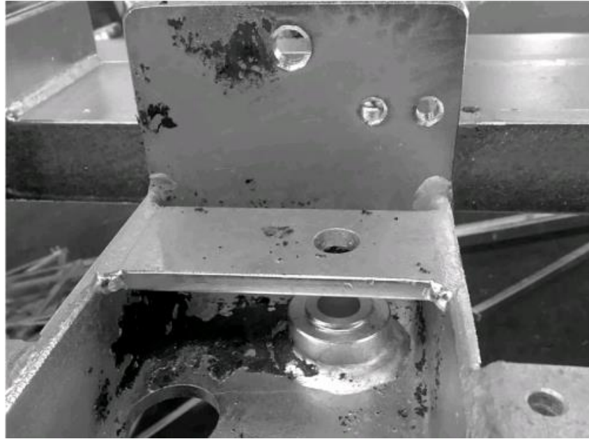
Figura 3.7: Manchas pretas em um substrato contaminado por uma substância pouco solúvel na solução de decapagem (KUKLÍK & KUDLÁČEK, 2016).
