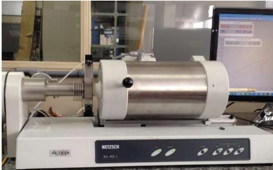
Fig. 13-Dilatômetro DL 402C utilizado para a sinterização dos corpos de prova.
