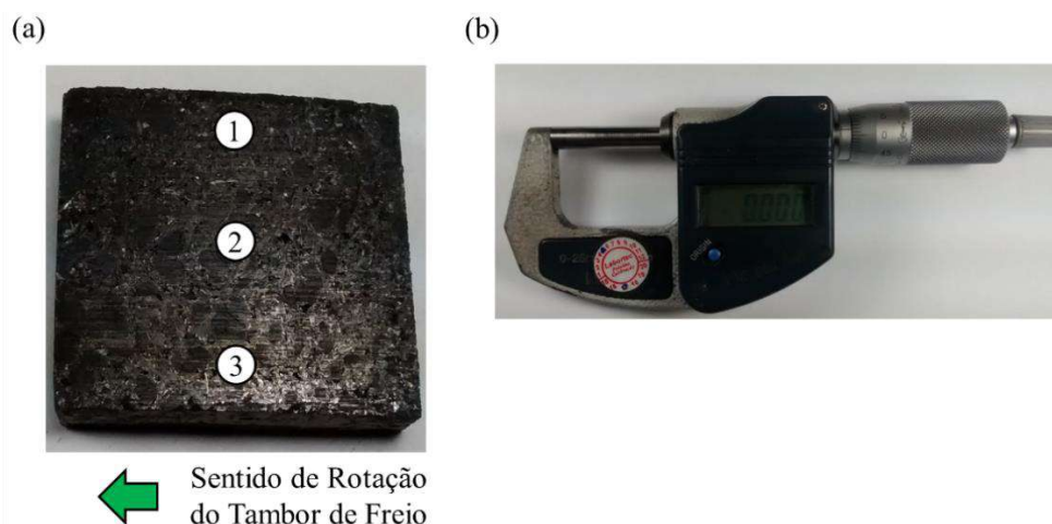
Fig. A.1 – (a) Pontos para Medição das Alturas dos Corpos de Prova; (b) Micrômetro Digital Utilizado nas Medições
