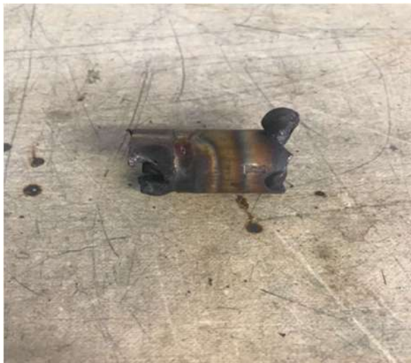
Figura 17 – Tubo 316L completamente danificado pelo processo de soldagem com aporte térmico de 0,3 KJ/mm.
