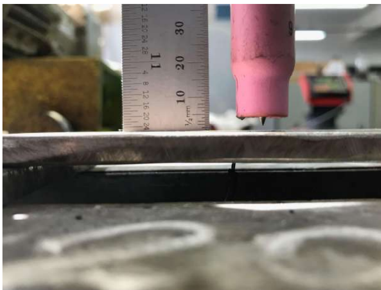
Figura 11 – Chapa posicionada para soldagem com distância de trabalho de trabalho igual a 2mm.
