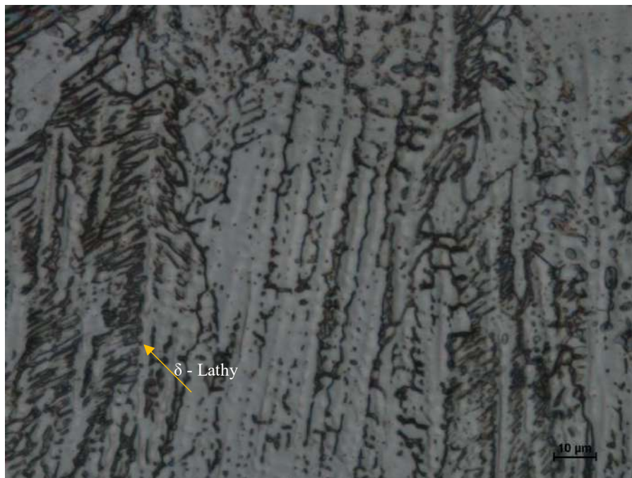
Figura 24 – Microestrutura \gamma / \delta da ZF da amostra S316L04 evidenciando presença de \delta em morfologia Lathy e pequeno espaçamento dendrítico secundário.
