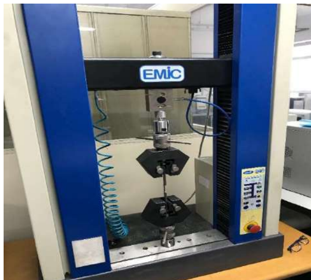
Figura 19– Máquina Universal de tração Instron Série 23 EMIC.
