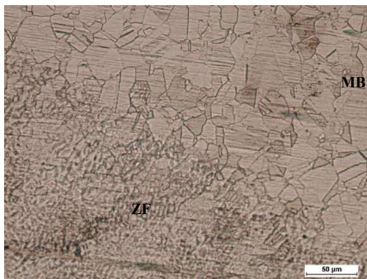
Figura 54– Micrografia da amostra S316LS1 evidenciando ZF dendrítica.
