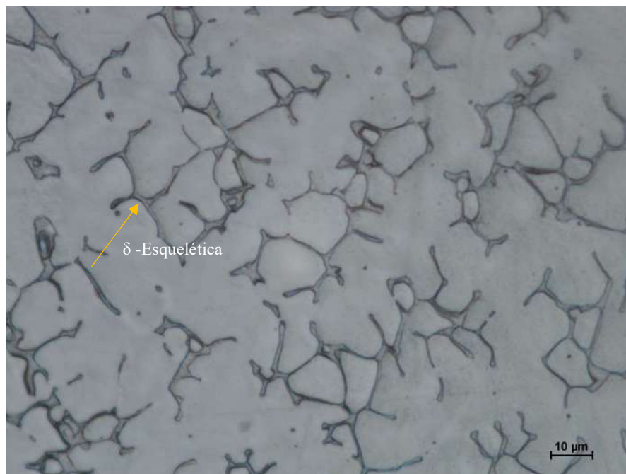
Figura 26– Microestrutura \gamma/\delta da ZF da amostra S316L16 evidenciando presença de \delta em morfologia Esquelética com evidente aumento do espaçamento secundário com o aumento do aporte térmico.
