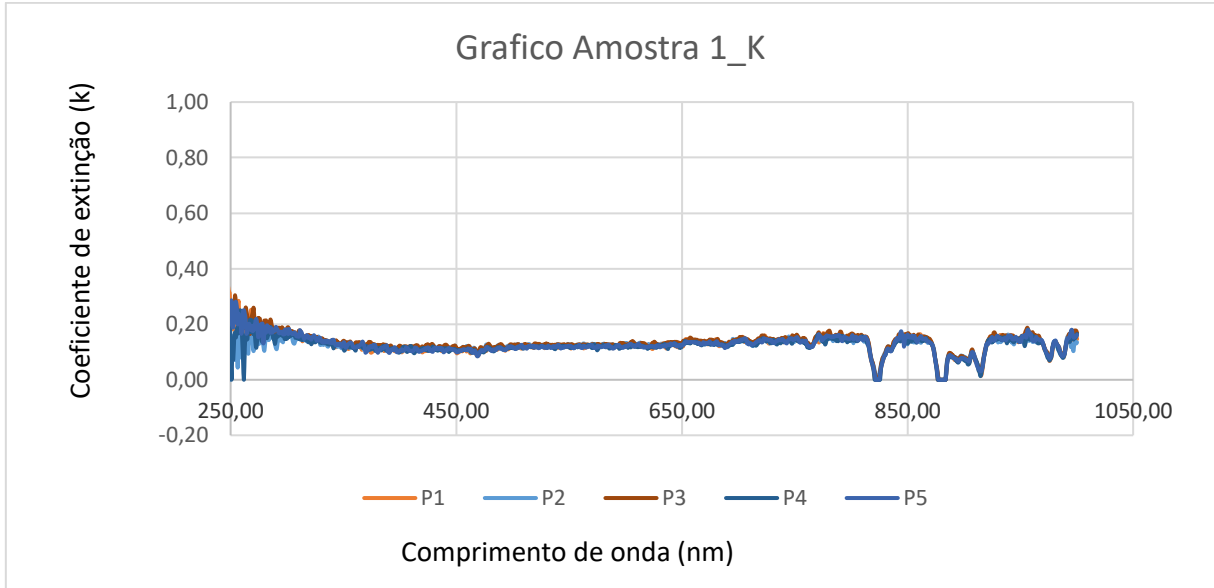
Figura 27 – Gráfico do coeficiente de extinção para amostra de 90% PP com 10% de talco. P1, P2, P3, P4 e P5 são pontos onde as medidas foram feitas.
