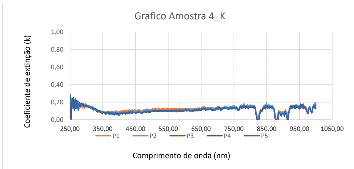
Figura 33 – Gráfico do coeficiente de extinção para amostra de 90% PPRec com 10% de talco. P1, P2, P3, P4 e P5 são pontos onde as medidas foram feitas.
