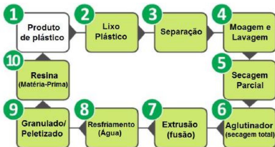
Figura 4 – Etapas do processo de reciclagem mecânica secundária.
