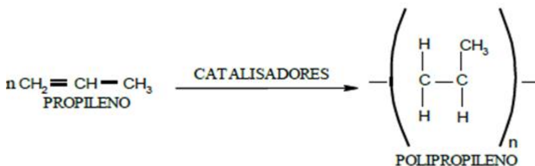
Figura 2 – Reação geral da polimerização do propileno.
