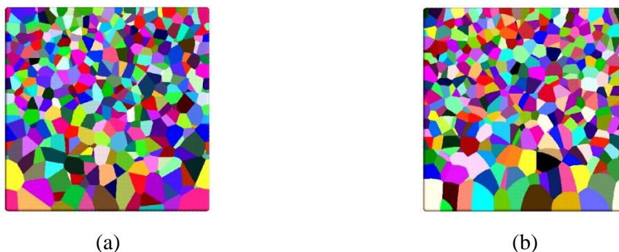
Figura 153 - Representação 2D que mostra a microestrutura simulada com nucleação não homogênea e velocidade de crescimento homogênea. Velocidade constante e gradiente de velocidade foram comparados. (a) G = 0,70 ; (b) G(x) = 1,0x + 0,2 para 4800 núcleos. O tamanho final do grão é menor na parte superior do que na parte inferior nos dois casos.
