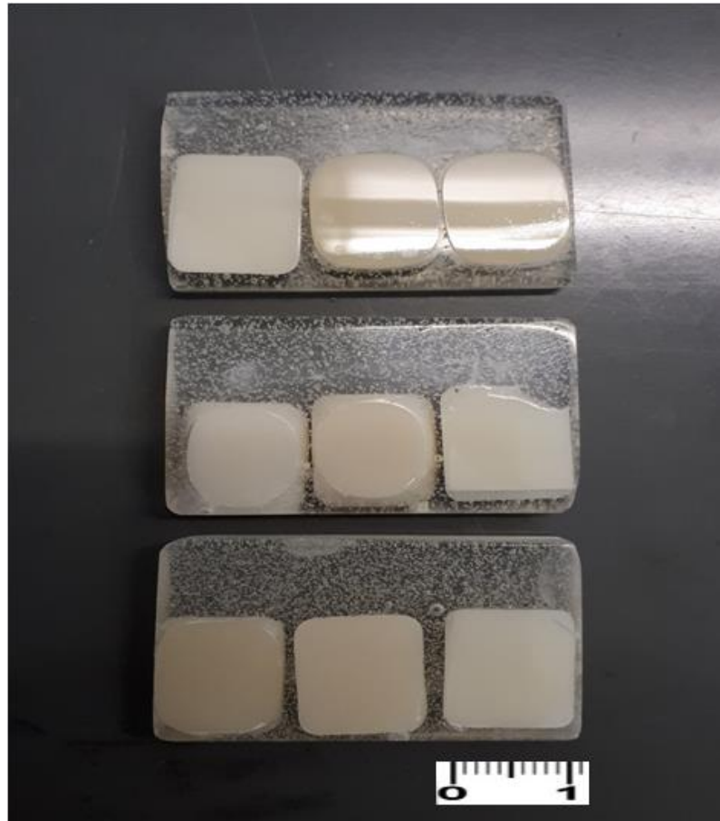
Figura 5 - Amostras de dissilicato de lítio embutidas em resina acrílica para ensaio de cisalhamento.
