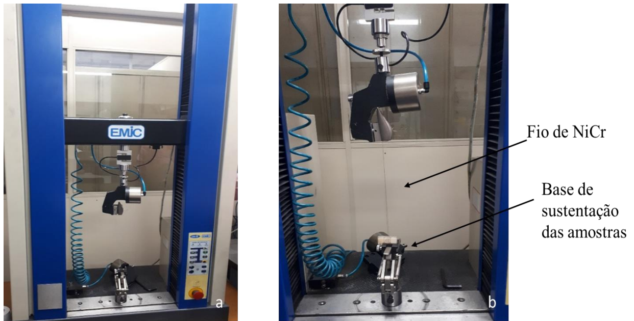
Figura 9 – Ensaio de cisalhamento: (a) Máquina universal para ensaios mecânicos EMIC DL10000; (b) Ensaio de cisalhamento em andamento de amostras de dissilicato de lítio ligados ao dispositivo de tração por um fio ortodôntico
