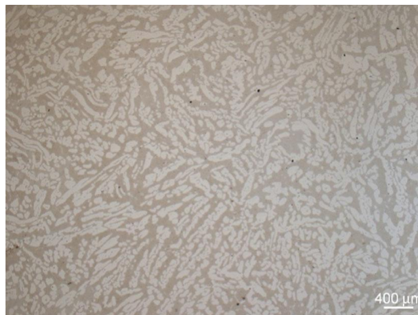
Figura 8. Micrografia representando um aço inoxidável duplex na condição comercial [23].
