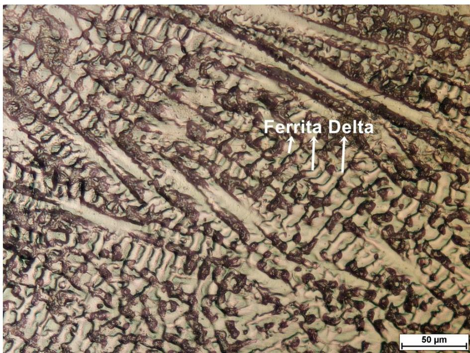
Figura 58. Microestrutura da ZF da Am 5. Ataque: Água Régia. Aumento: 200X.
