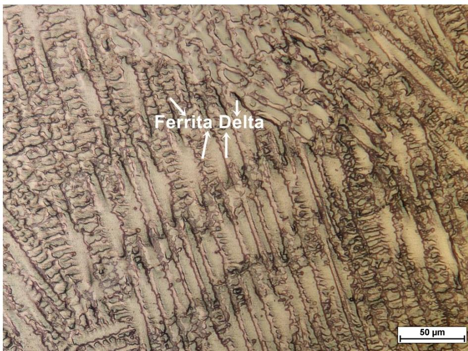
Figura 60. Microestrutura da ZF da Am 7. Ataque: Água Régia. Aumento: 200X.
