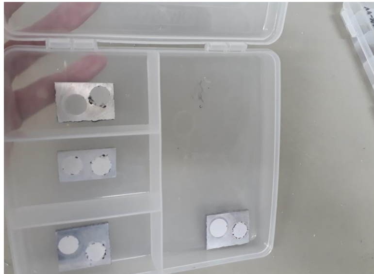
Figura 5.9. Aspecto superficial das amostras após processo de oxidação anódica a microarco. O círculo da esquerda corresponde à anodização a -25^{\circ}\text{C} , e o da direita, a 25^{\circ}\text{C} .
