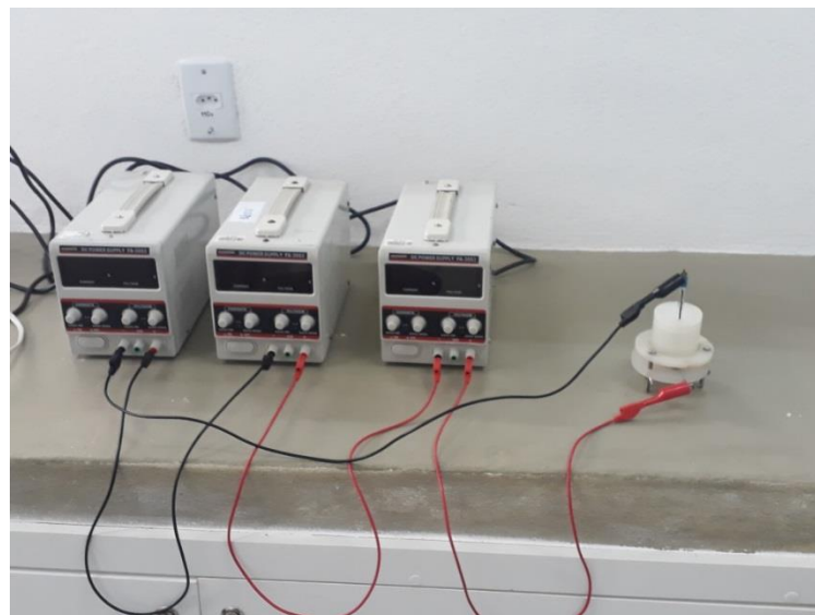
Figura 5.7. Montagem do sistema eletroquímico para realização da técnica de oxidação anódica a microarco.
