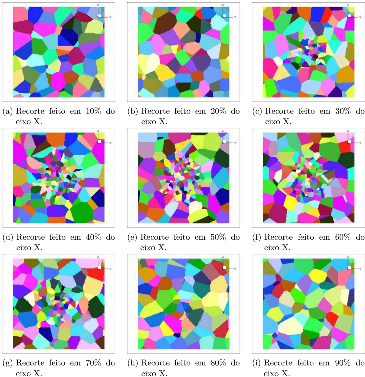
Figura 54 – Recorte das seções transversais da microestrutura representada na figura 50f.
