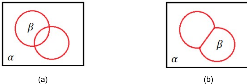
Figura 3.4: Esquematização do crescimento da nova fase: (a) Volume estendido; (b) Impingement
