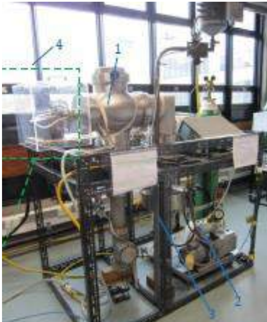
Figura 15 - Aparato de fusão preparado por Yu Lu, 1) câmara de vácuo, 2 e 3) sistema de vácuo, 4) sistema de rotação do cadinho, adaptado (Lu Y. 2014)
