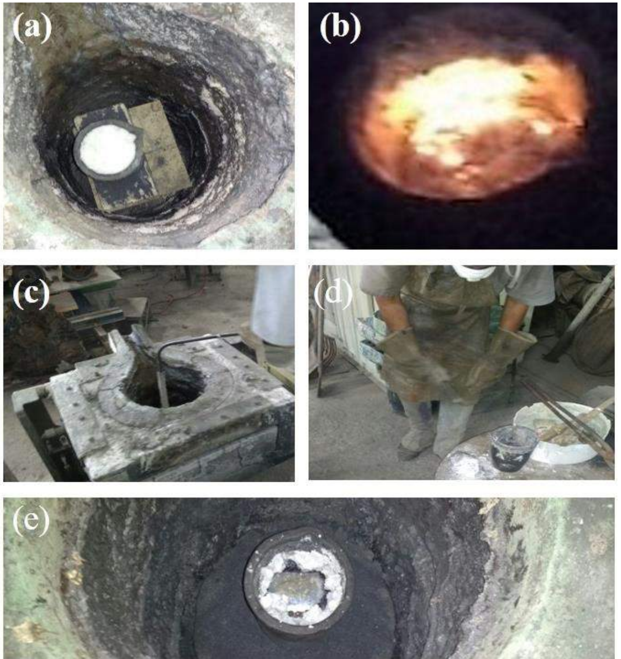
Figura 32 – Posicionamento da carga dentro do forno (a), fusão protegida com os gases da carga salina (b), medição de temperatura (c), resfriamento ao ar da liga Mg-Zn-Ca na fusão (d), Carga em fusão com proteção da atmosfera de proteção (e), autor.
