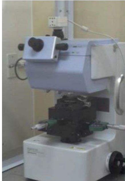
Figura 39 - Ultramicrodurômetro Shimadzu DUH-211S com uso de indentedor do tipo Vickers, autor.
