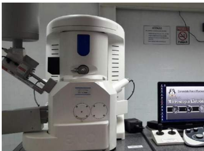
Figura 37 - Microscópio Eletrônico de Varredura (MEV - ZEISS EVO-10) utilizado para as análises microestruturais descritas nesse trabalho, autor.
