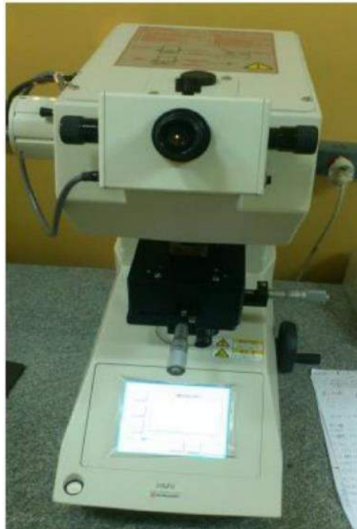
Figura 38 - Microdurômetro modelo HVM-2T utilizado na medição da dureza Vickers, autor.
