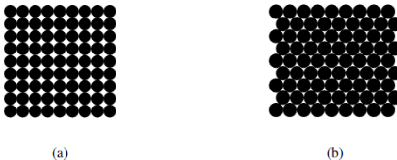
Figura 1: Influência do Arranjo das Partículas do Solo na sua Compacidade. Em (a), Porosidade Igual a 0,2146. Em (b), Porosidade Igual a 0,0931. (Neves, 2009).
