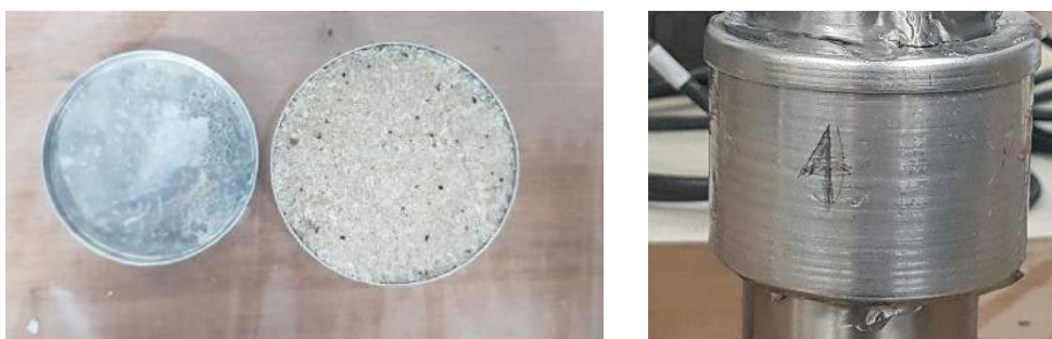
Figura 14: Amostra de Areia Saturada. Em (a) Vista Superior da Amostra de Areia Saturada Moldada em Cápsula de Alumínio. Em (b) Amostra de Areia Saturada, Fechada, em Cápsula de Alumínio.
