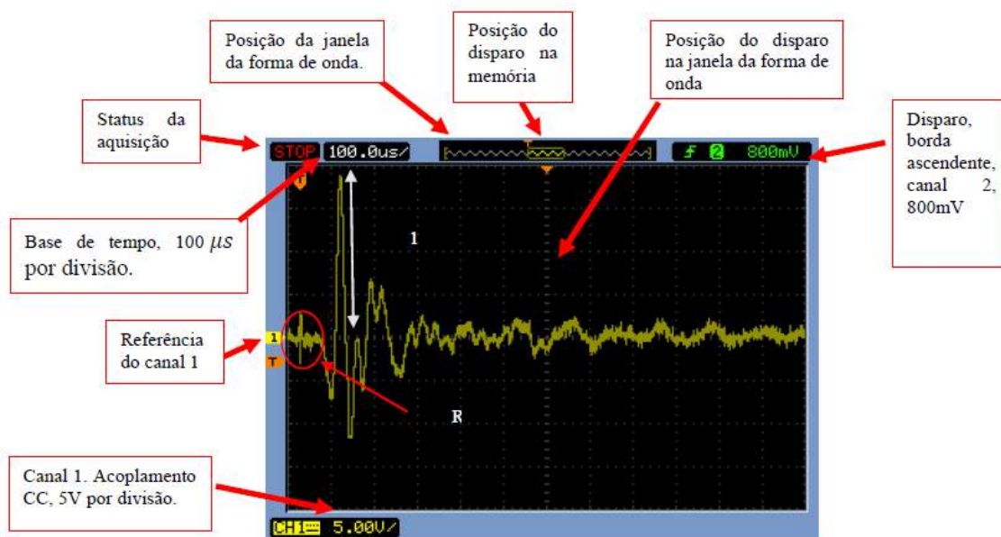
Figura 19: Tela do Osciloscópio (Ferronato, 2016).
