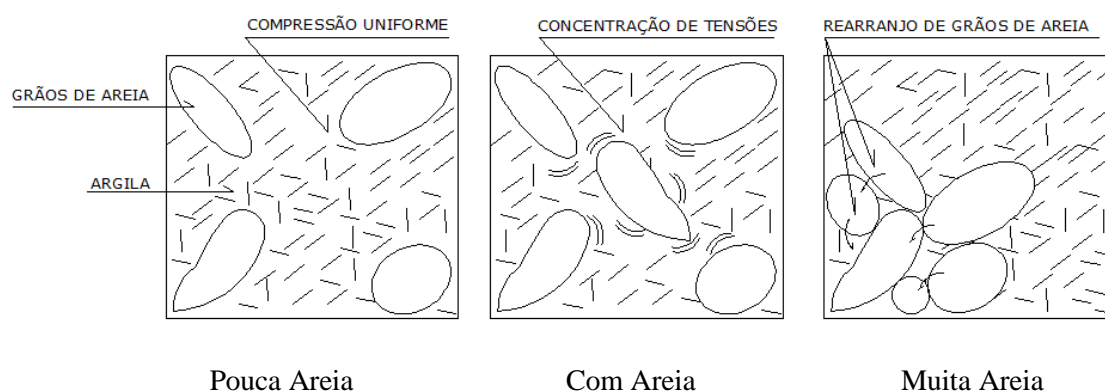
Figura 3: Misturas de Argila com Areia e os Respectivos Comportamentos de seus Grãos, durante a Compressão. (Cunha, 2012)
