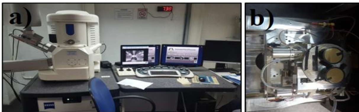
Figura 16. Microscopia eletrônica de varredura com espectroscopia por dispersão de energia. a) Panorama do equipamento e b) Visão da amostra.
