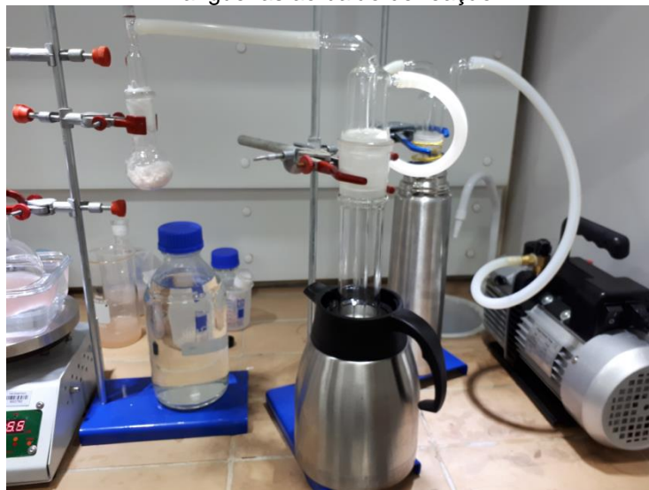
Figura 32– Secagem do copolímero em dibloco obtido utilizando bomba à vácuo acoplada com mangueiras ao balão de reação.
