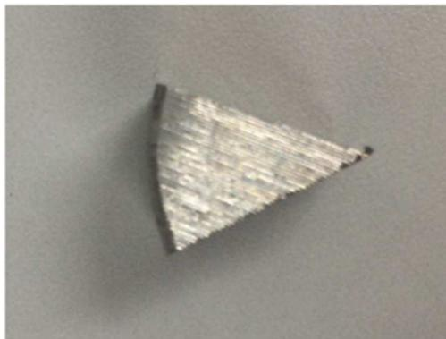
Figura 14 Amostra cortada do aço inoxidável duplex SAF 2205 utilizada para o tratamento térmico de envelhecimento.
