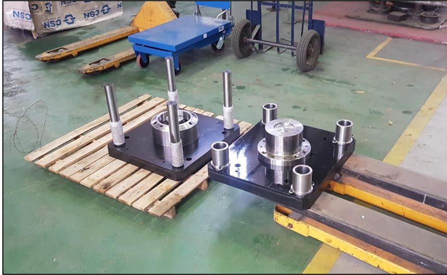
Figura 35 – Pré-montagem do ferramental.
