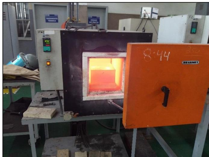
Figura 17 – Processo de tratamento térmico do ferramental (CSN, 2018).
