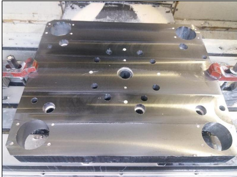
Figura 15 – Usinagem da base inferior do ferramental via CNC (CSN, 2018).
