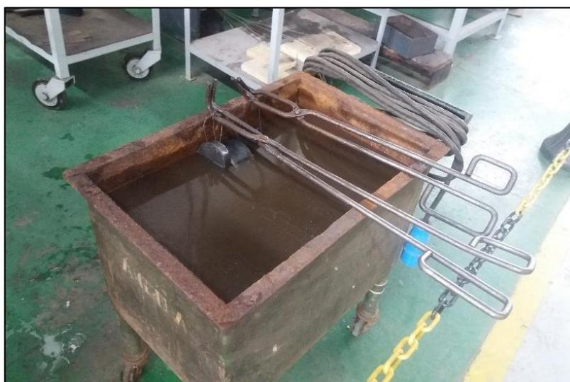
Figura 18 – Tanque de água para resfriamento (CSN, 2018).
