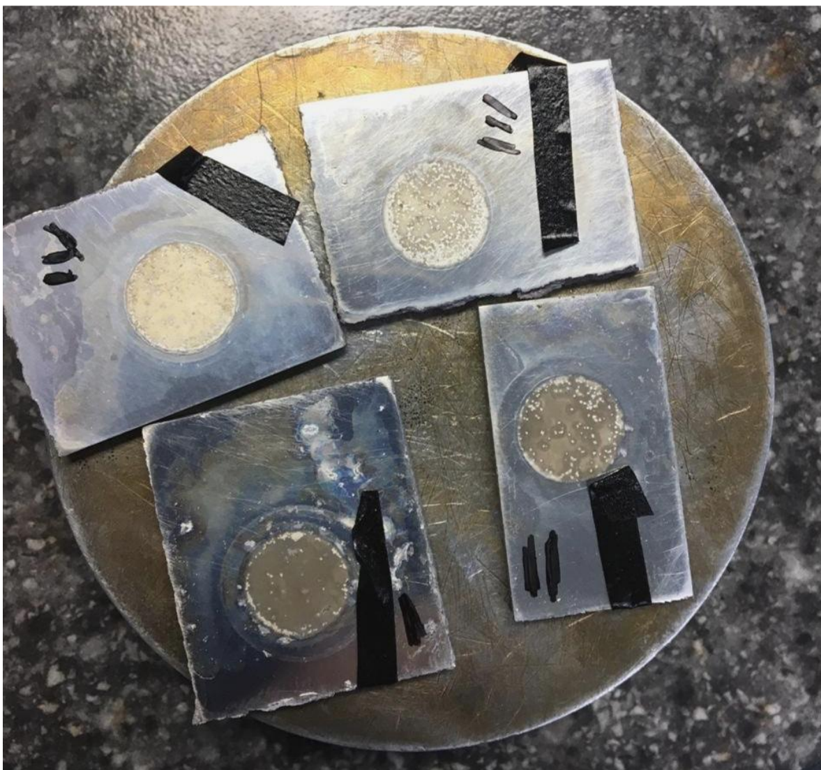
Figura 33 - Amostras posicionadas no porta amostra, para análise no MEV, após ensaio de curva de polarização.
