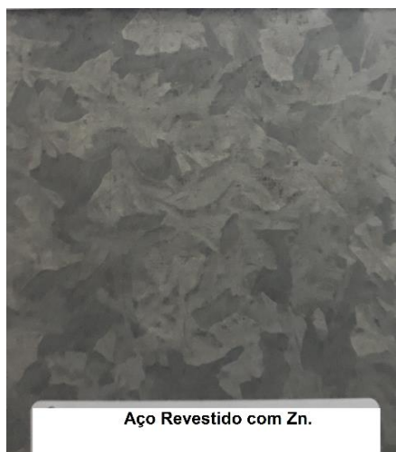
Figura 27: Aço revestido com Zn após 75 dias de exposição em campo.
