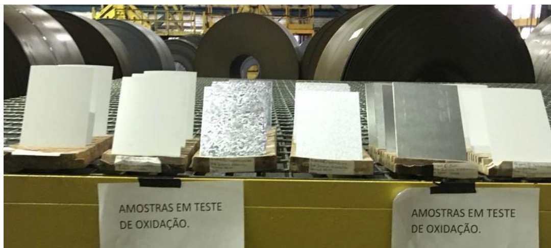
Figura 15: Amostras de aço expostas em área de decapagem ácida.
