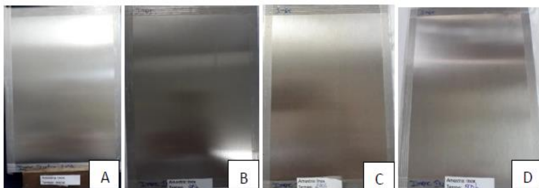
Figura 18: Aço inoxidável duplex SAF 2205. A) Antes do ensaio de névoa salina. B) Após 48 h de ensaio. C) Após 240 h de ensaio. D) Após 500 h de ensaio.
