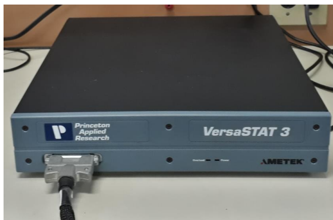
Figura 12: Potenciostato/galvanostato VersaStat 3+ da marca Princeton Applied Research utilizado nos ensaios eletroquímicos.
