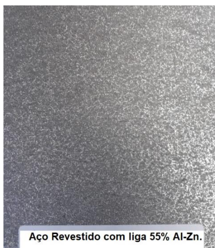
Figura 28: Aço revestido com liga 55% Al-Zn após 75 dias de exposição em campo.
