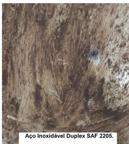
Figura 31: Aço inoxidável duplex SAF 2205 após 1 ano de exposição em campo. A) Sem limpeza. B) Após limpeza.
