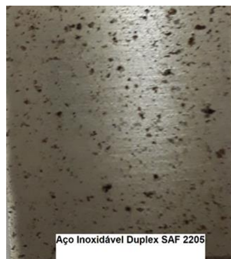
Figura 31: Aço inoxidável duplex SAF 2205 após 1 ano de exposição em campo. A) Sem limpeza. B) Após limpeza.
