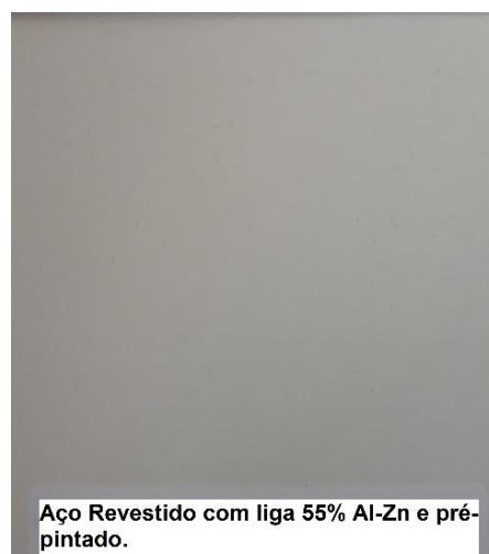
Figura 29: Aços pré-pintados após 75 dias de exposição em campo. A) Revestido com Zn e pré-pintado. B) Revestido com liga 55% Al-Zn e pré-pintado
