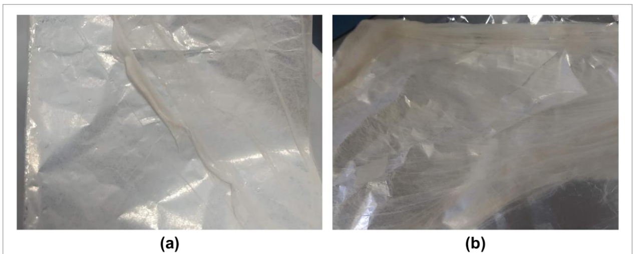
Figura 17: Amostras das fibras produzidas e coletadas em papel alumínio com (a) 1,00 e (b) 1,70 % de NPs incorporadas. (Fonte: próprio autor)
