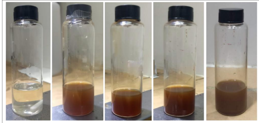
Figura 12: Soluções poliméricas preparadas para fiação. Concentração de NPs em relação a massa total de polímeros, da esquerda para a direita: 0; 1,00; 1,25; 1,50 e 1,70 % de NPs. (Fonte: próprio autor).
