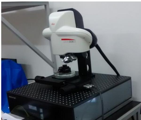
Figura 24: Microscópio Confocal Interferométrico Leica DCM 3D usado no estudo.
