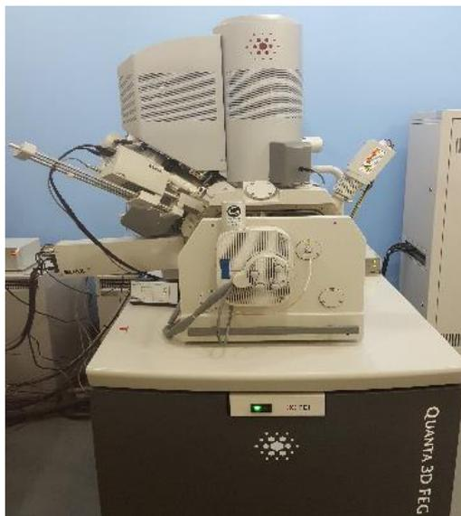
Figura 20: Microscópio Eletrônico de Varredura FEI QUANTA 3D FEG 450.
