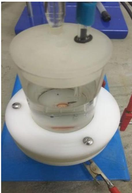
Figura 22: Células eletroquímicas do tipo Tait.
