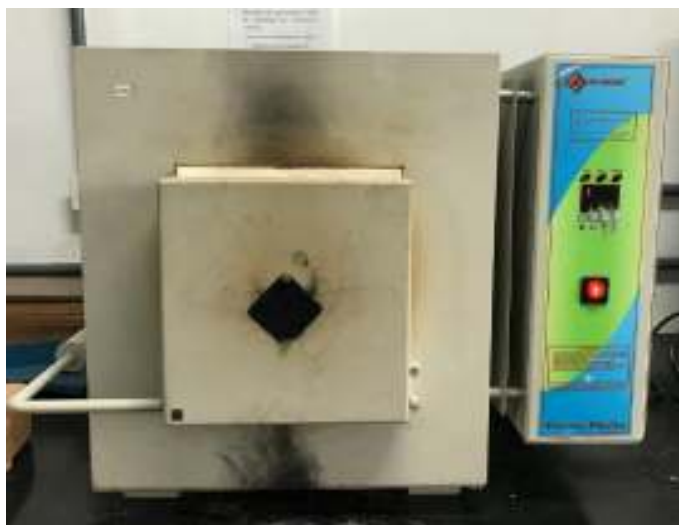
Figura 12: Forno sendo usada para síntese do vidro.
