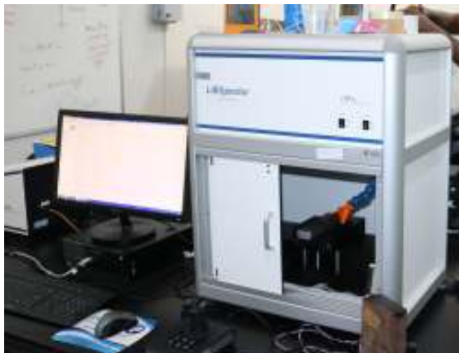
Figura 22: LIBSpector (camara óptica).
