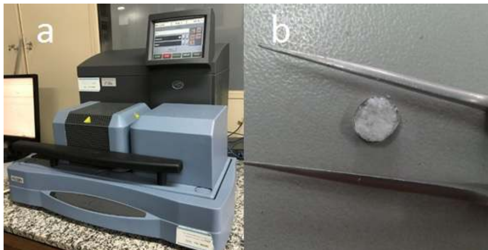
Figura 25: a) DSC SDT Q600; b) Cadinho de alumina com vidro macerado sem cobre.
