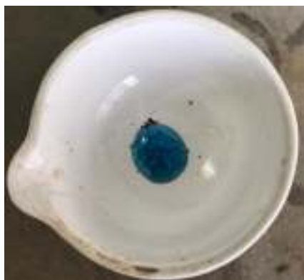
Figura 60: Vidro após recozimento a uma temperatura maior que 500°C.
