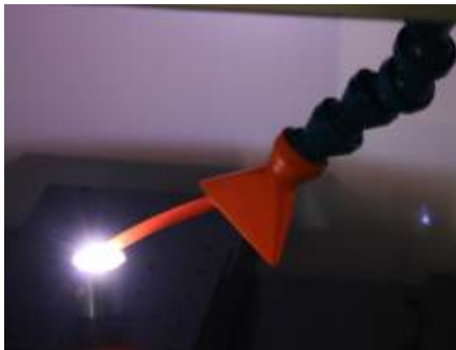
Figura 21: Foto tirada no momento da formação do plasma por laser pulsado na técnica LIBS. A extremidade vermelha é da saída de gás Ar.
