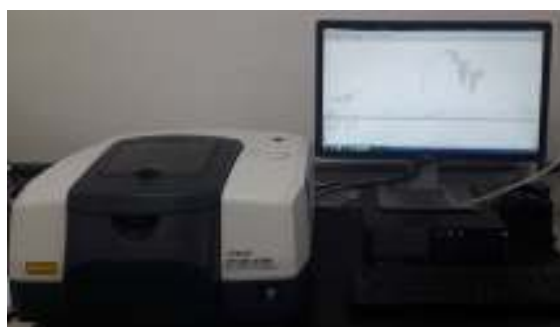
Figura 27: equipamento para a espectroscopia no infravermelho: Espectrômetro FT/IR – 4700.
