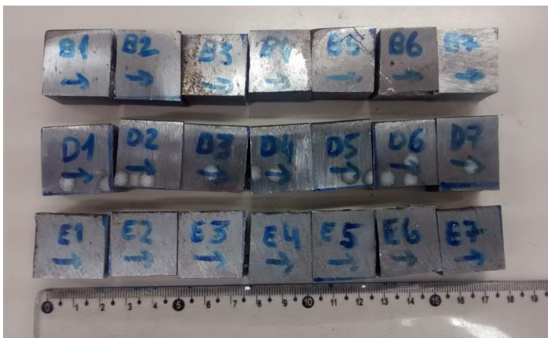
Figura 28 - Amostras cortadas prontas para embutimento.
