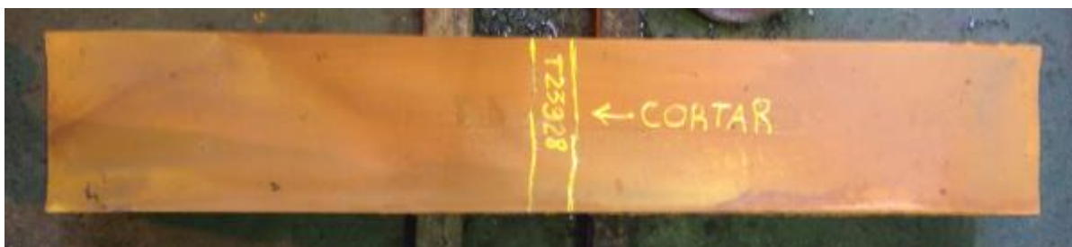
Figura 26 - Detalhamento da região do corte do bloco a partir da amostra de placa.
