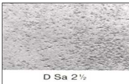
Figura 12 - Padrão fotográfico do grau de preparação da superfície, Fonte: Norma ISO 8501 Fev. 2011[67].
