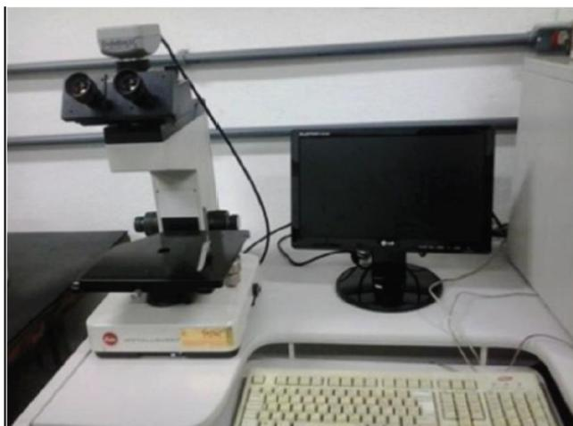
**Figura 36** – Microscópio Leitz Metallovert.
