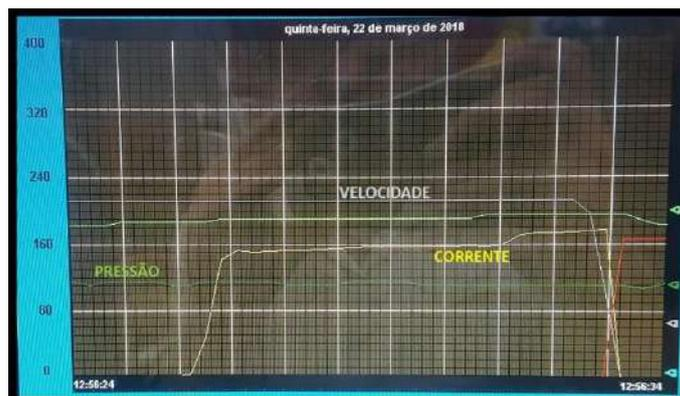
**Figura 56.** Registro dos valores instantâneos dos parâmetros corrente, velocidade e pressão (amostra 13).
