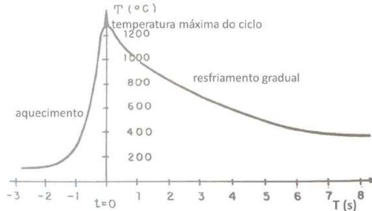
**Figura 7.** Ciclo térmico de um processo de soldagem. Fonte: Adaptado de Wainer, Brandi e Mello (2015).
