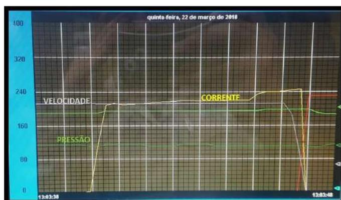
**Figura 58.** Registro dos valores instantâneos dos parâmetros corrente, velocidade e pressão (amostra 15).
