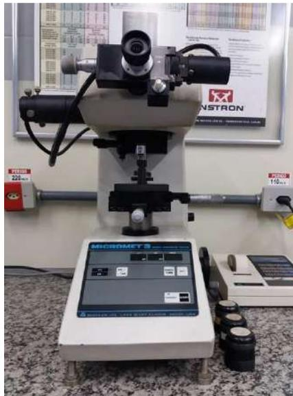
**Figura 39.** Microdurômetro utilizado no ensaio de dureza. Local: Centro de Pesquisa da CSN.
