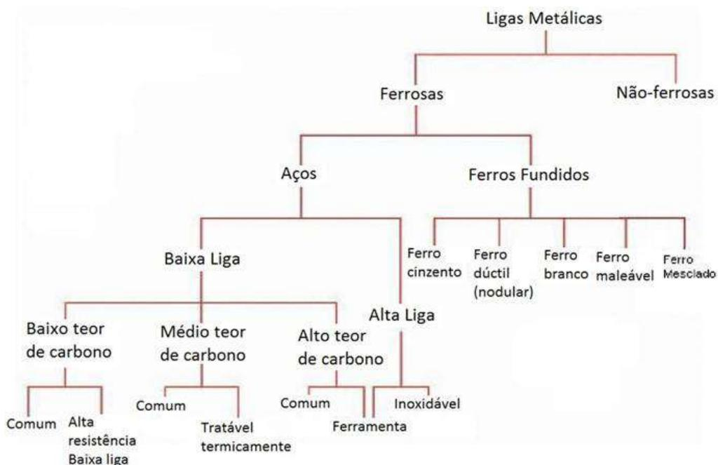
**Figura 4.** Classificação das ligas metálicas ferrosas. Fonte: Adaptado de Callister Jr. e Rethwisch (2016).
