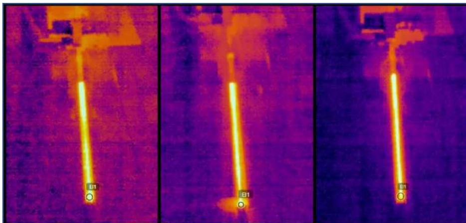
**Figura 103.** Análise termográfica no ponto fixo inicial das soldas de aporte 3,64 J/mm, 5,09 J/mm e 6,38 J/mm, respectivamente.
