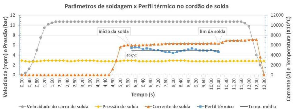
**Figura 60.** Correlação dos parâmetros de soldagem com o perfil térmico do cordão de solda (amostra 13).
