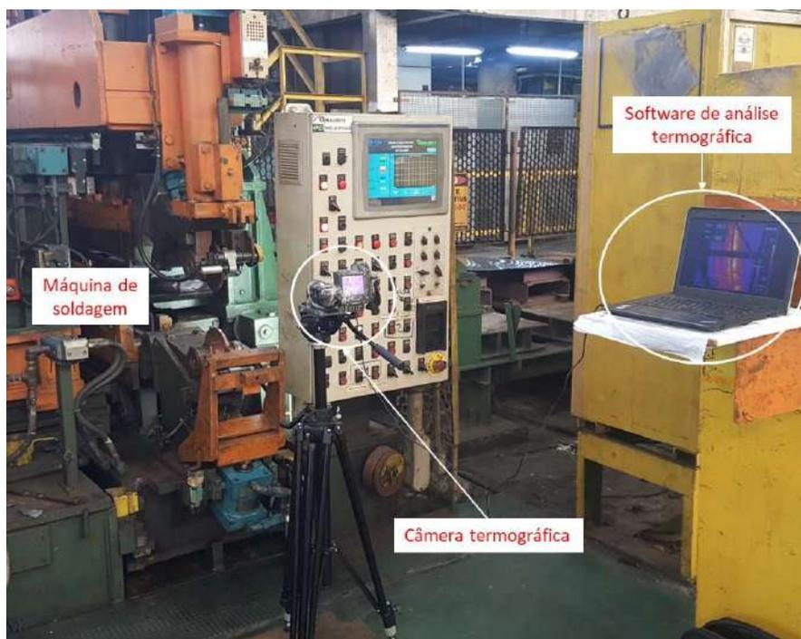
**Figura 30.** Equipamentos de captação da imagem térmica dos cordões de solda.
