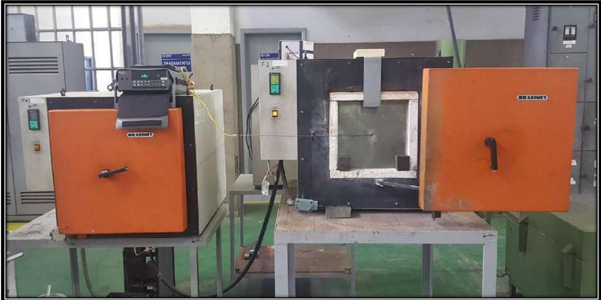
**Figura 27.** Preparação dos equipamentos e instrumentos para o ensaio de emissividade do material. Local: Centro de Pesquisa da CSN.
