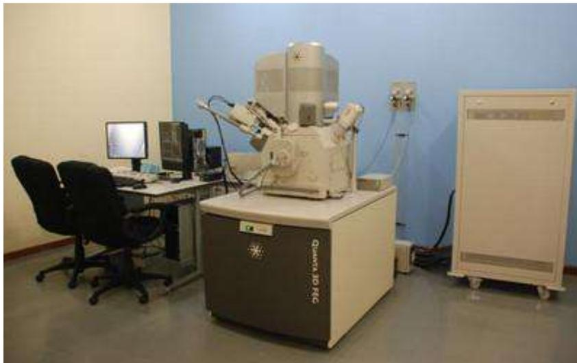
**Figura 41.** Microscópio eletrônico de varredura utilizado na identificação de fases. Local: Centro de Pesquisa da CSN.
