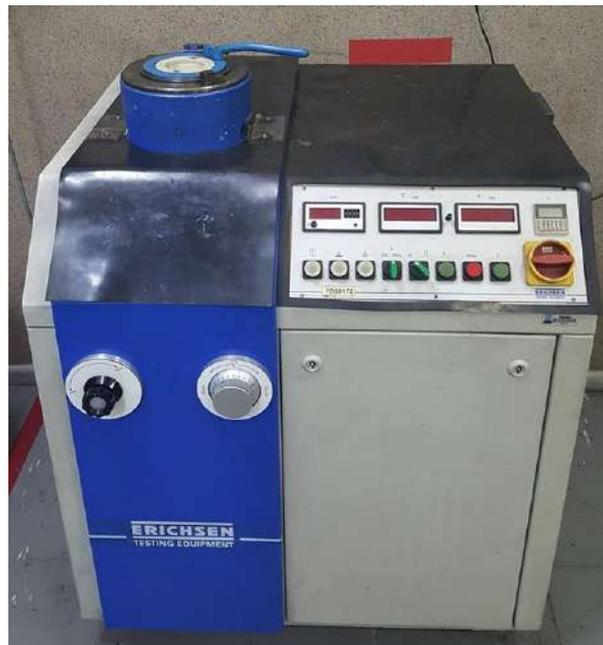
**Figura 34.** Equipamento utilizado no ensaio de embutimento Erichsen. Local: Centro de Pesquisa da CSN.
