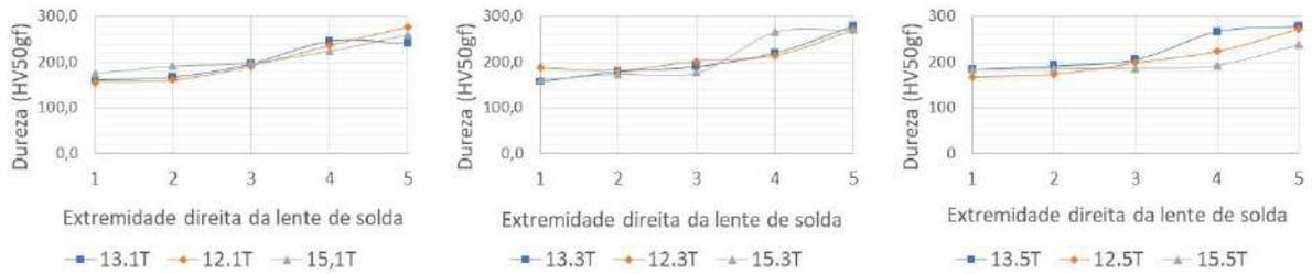
**Figura 87.** Comparação dos perfis de dureza na extremidade direita das lentes de solda.
