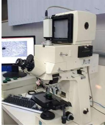
**Figura 38.** Microscópio utilizado na caracterização dos perfis de solda. Local: Centro de Pesquisa da CSN.
