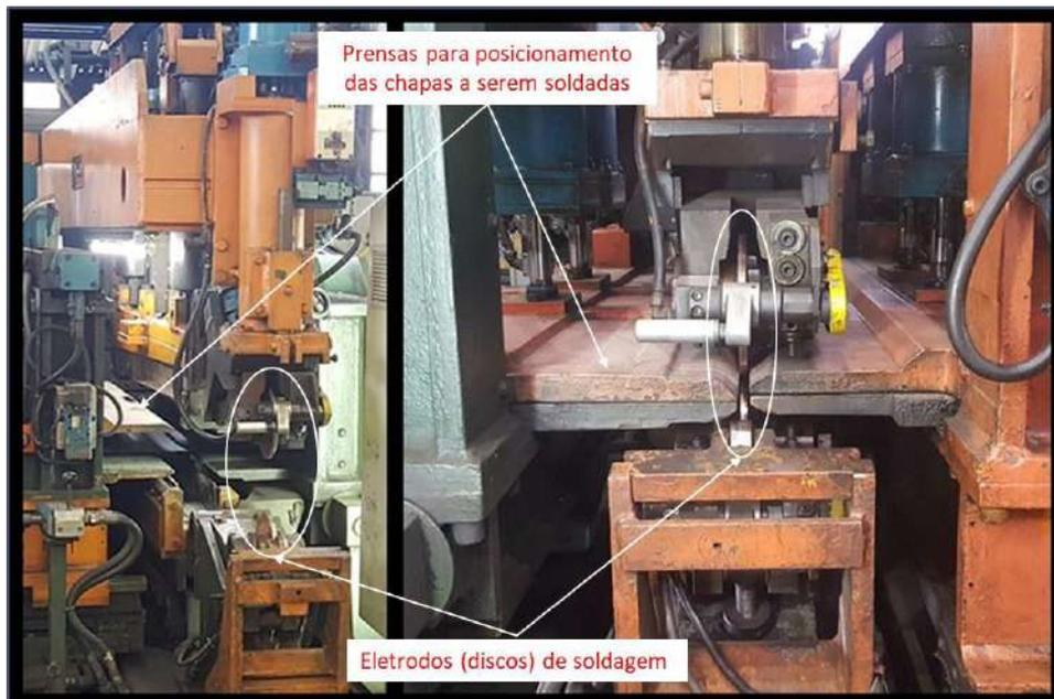
**Figura 29.** Imagens da máquina de soldagem a resistência elétrica por costura alvo do experimento.
