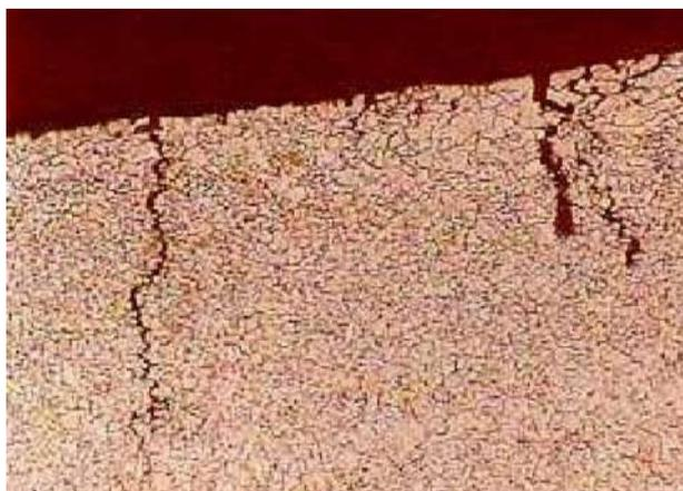
**Figura 13.** Imagem obtida por metalografia mostrando a seção transversal de uma solda a ponto com a presença de micro trincas na superfície do ponto de solda. Ataque Nital 2%, 200X. Fonte: Adaptado de Stocco (2010).
