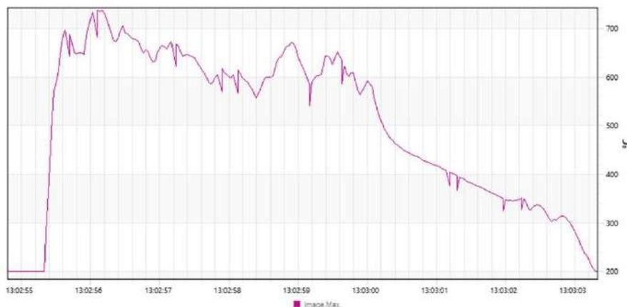
**Figura 31.** Exemplo de curva térmica automática (temperatura máxima) para um cordão de solda obtido via software Flir Tools.
