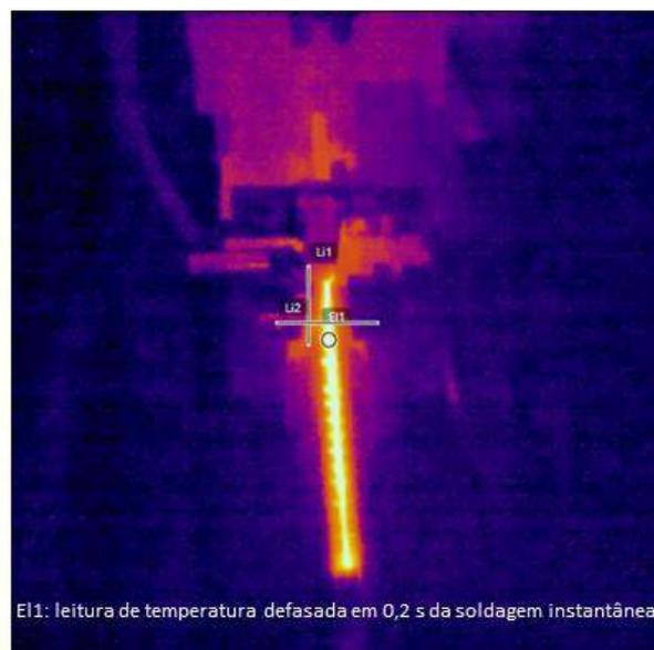
**Figura 32.** Metodologia desenvolvida para o registro manual de informações via software Flir Tools.
